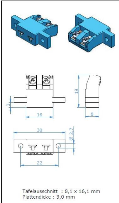
Einzel Einbaukupplung zur Montage in Frontblechen, Gehäusen, usw. Befestigung mit zwei Schrauben M 2,5 (Schrauben nicht im Lieferumfang enthalten)
